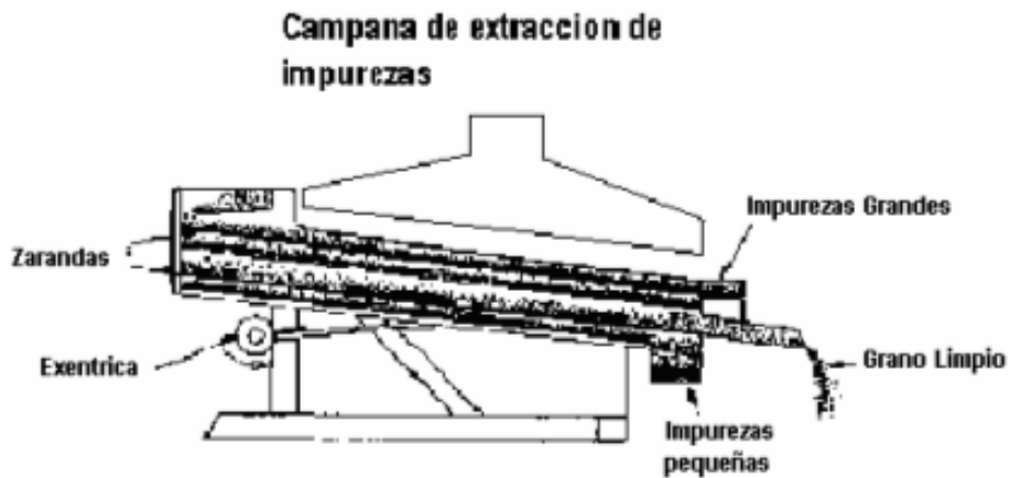
Fig 4.1 Sistema de limpieza de zarandas y ventilador
