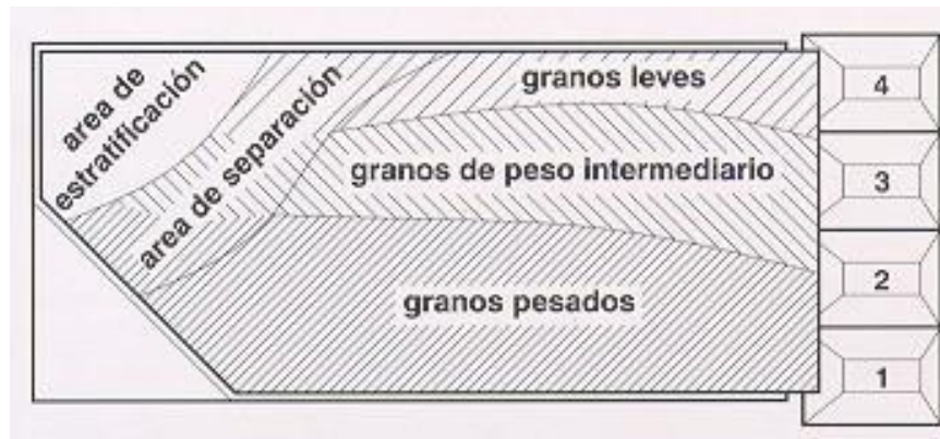
Figura 2.11 Vista de planta de la mesa densimétrica.
