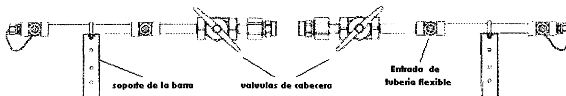
Fig. 5.4.1.1 barra de extensión para los cilindros.
