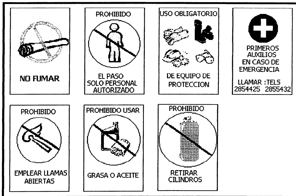
Fig. 8.9 SEÑALIZACIONES COMUNMENTE USADAS EN CENTRALES DE GASES
