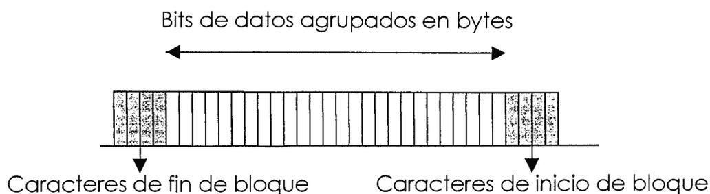
Figura 4.4 Transmisión sincrónica.
