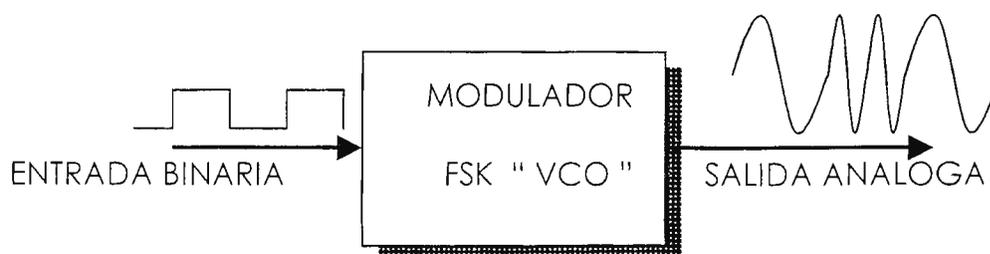
Figura 3.10 Modulador FSK utilizando VCO.
