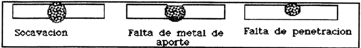
Fig. 9 Socavación, Falta de metal de aporte, falta de penetración
