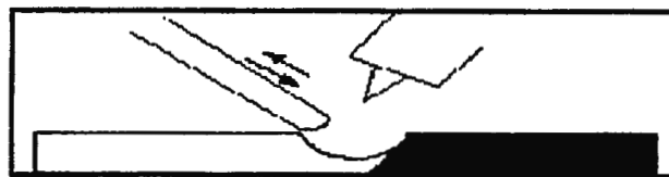
Fig. 11 Separación de los bordes igual a 1/4 de grueso del material a soldar
