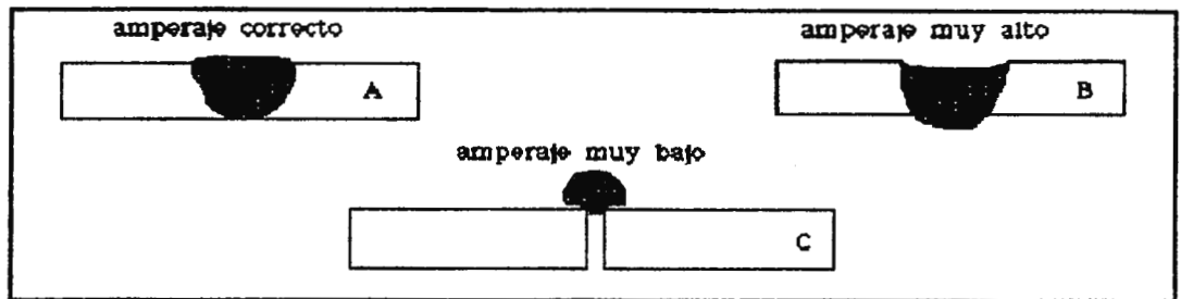
Fig. 3.13 Efectos del amperaje en uniones soldadas
