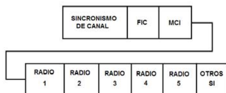
Figura 3.67 Configuración de la radio digital DAB.
