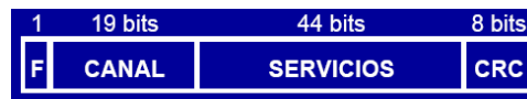
Figura 3.39 Organización de los bits dentro de la trama en el canal FAC.
