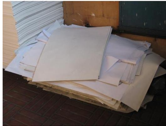
Pliegos de Papel deteriorados por las condiciones inadecuadas de la Bodega de Materia Prima
