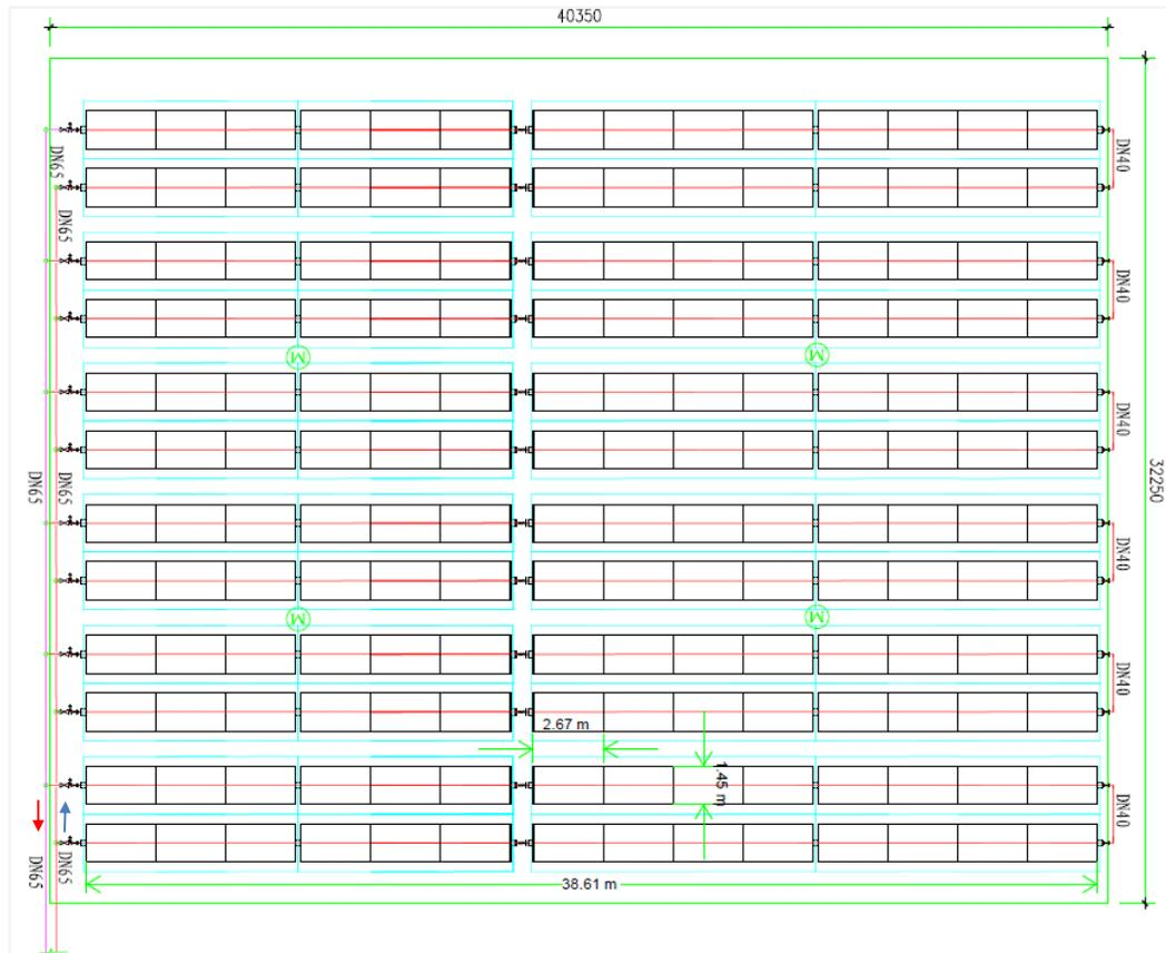
Figura 23 Configuración de campo de 168 CCPs, en arreglo de 6 lazos en paralelo con 28 CCPs en serie cada uno (VICOT, Propuesta Técnica, 2020).
