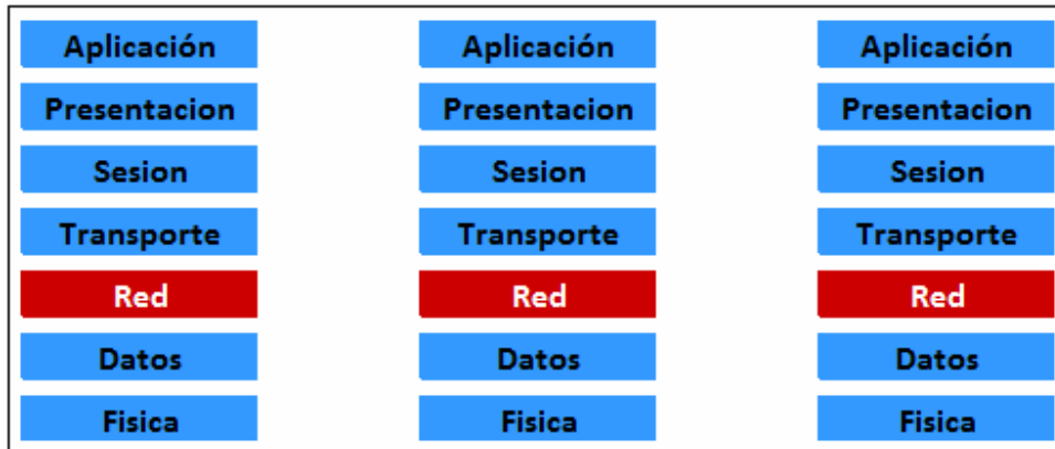
Figura 1.2 Ilustración de la operación en las capas del modelo OSI del filtrado de paquetes
