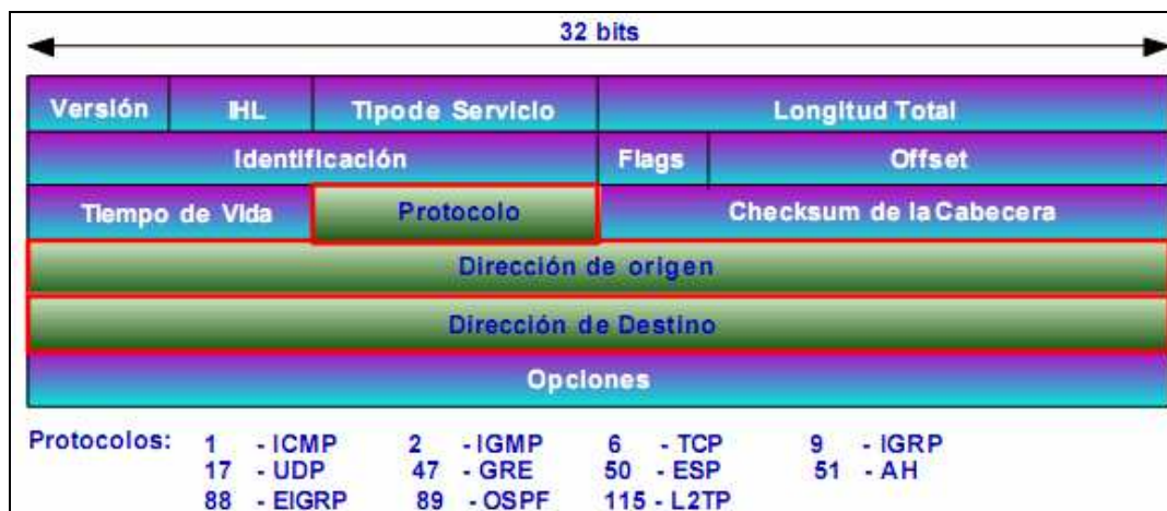
Figura 1.7. Cabecera de un paquete IPv4. Muestra los campos que habitualmente inspeccionan estos firewall y los Protocolos mayormente usados.
