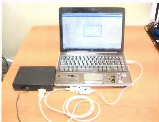
Figura 5.2 Conexión del tasador hacia la PC a través del cable serial.
