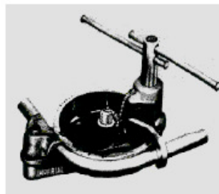
Fig. 2 equipo y herramienta para doblar tubo de cobre y de sección circular
