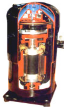
Figura 2- Seccionado de un compresor hermético tipo Scroll
