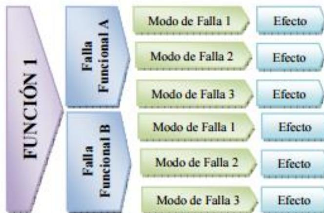
Figura 2.3 Diagrama de proceso de análisis de modos de falla y efecto
