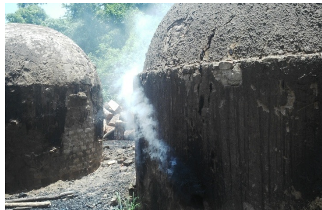
Imagen 32. En las fotografías de arriba se puede apreciar a los hornos durante los procesos de producción de carbón
