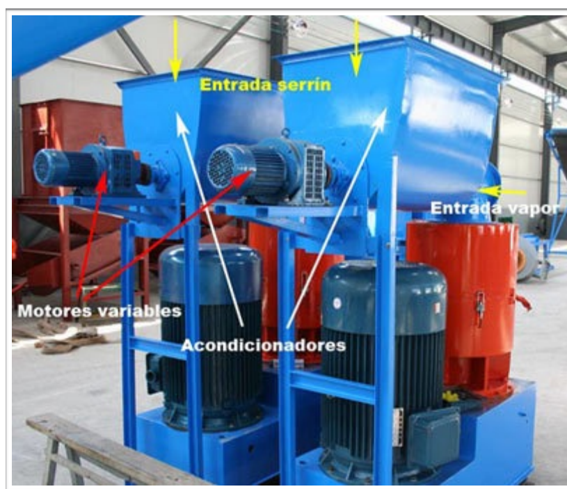
Imagen 21. Acondicionador – mezclador de una planta de pellets que incorporan dos peletizadoras de plantilla plana F550
