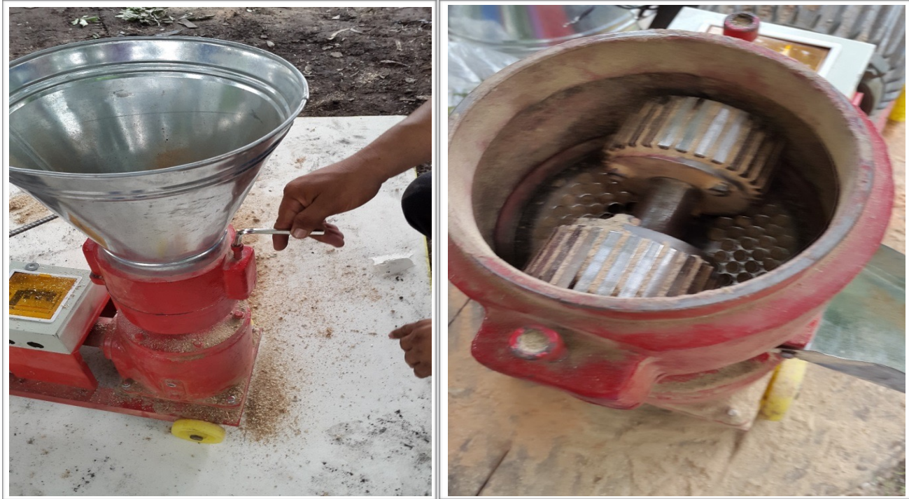
Imagen 46. Ajuste de la presión de los rodillos fijos
