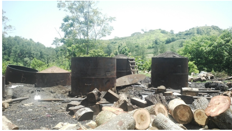
Imagen 33. Se muestra el cilindro y cono cuyas partes conforman el horno metálico para la producción de carbón
