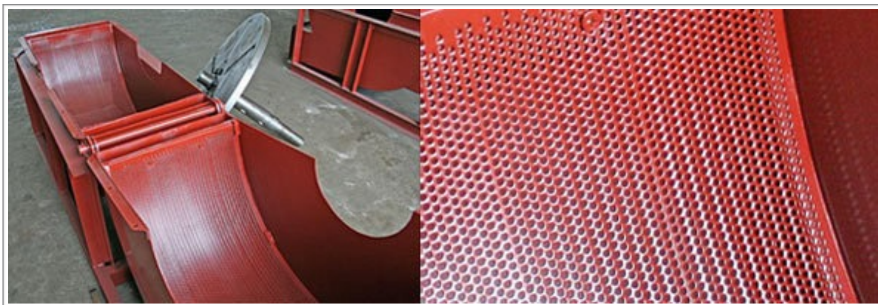
Imagen 13. Esta es la vista interna de la trituradora mixta de la malla que define el diámetro y textura final del material triturado.
