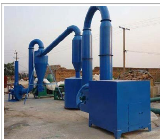
Imagen 19. Secador por sistema de tuberías
