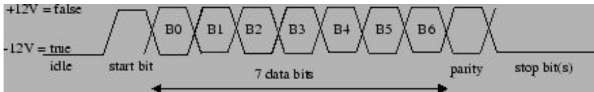
Figura: 5.6.3.6: Paquete de bits de un RS-232 (1 bit de arranque, 7 bits de datos, 1 bits de paridad, y 2 bits de parada)
