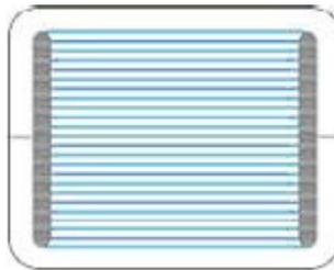
**Figura 4.38:** Dirección de las líneas de flujo entre las dos placas iguales dispuestas paralelamente
