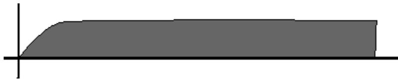
**Figura 4.9:** Forma de la corriente continua o galvánica
