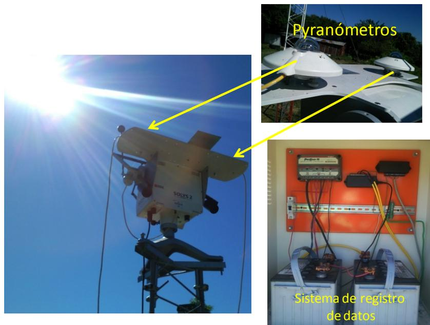
Figura 2: Equipo de seguimiento y medición de radiación solar global y difusa y sistema de registro de datos, estación Comalapa, LaGeo.
