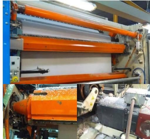
Figura 4.11 Módulo perforador / rebobinador
