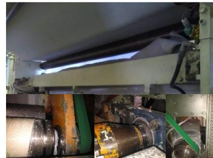
Figura 4.4. Módulo perforador/rebobinador
