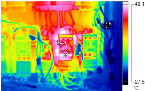
Tablero de *potencia y control* de bombas de enfriamiento en proceso de esterilizado.
