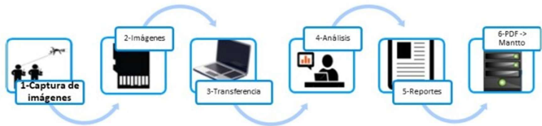
Figura 3.1 Flujo actual del proceso de inspección de líneas de transmisión (Fuente: Elaboración propia)
