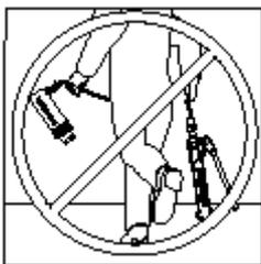
**IMPORTANTE:** No levantar el equipo hidráulico por las mangueras o acopladores giratorios. Usar el mango de transporte u otros medios para transportarla con seguridad. Siempre acarrear la bomba tomándola del asa. Si se acarrea de la manguera se puede dañar la manguera y/o la bomba.
