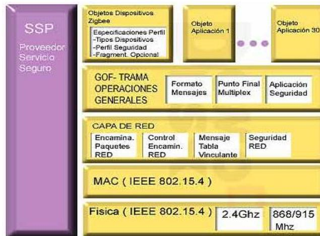
Dicha arquitectura muestra la construcción interna del Zigbee.
