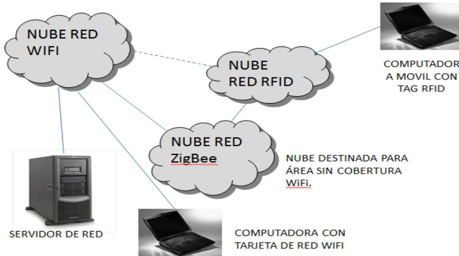
En este caso, contamos con la cobertura especial, la Nube ZigBee, cubrirá las áreas donde la WiFi no llega, otra ventaja es que RFID, puede usar el ancho de banda de ZigBee para comunicarse con el servidor, de la misma forma el personal puede ser controlado por medio de su tag asignado.
