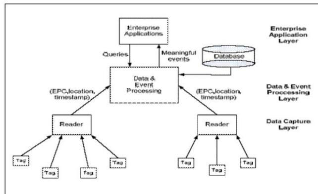
Todo sistema RFID se compone de un interrogador o sistema de base que lee y escribe datos en los dispositivos y un transponder o transmisor que responde al interrogador.
