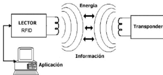
Observemos un diagrama simple de cómo funciona el RFID, contaríamos con una aplicación informática, la cual se encargaría de llevar el registro de los equipos o bienes que se estén monitoreando, luego esta aplicación se conectaría a los lectores quienes mandan una señal de radio frecuencia la cual es recibida por los transponder.
