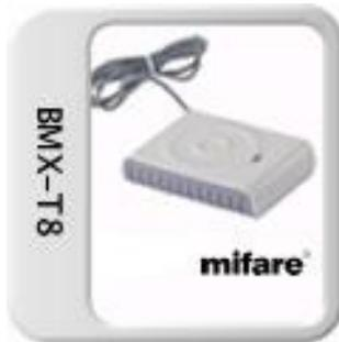
Lector / grabador de proximidad HF ( High Frequency - Alta Frecuencia) a 13,56 MHz ISO 14443A, ISO 14443B, ISO Plug&Play. Mifare Con interface USB
