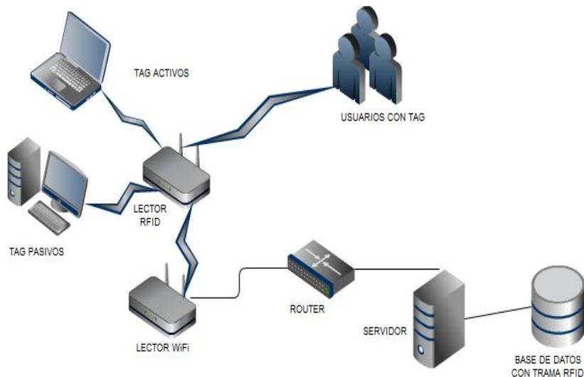
La Figura 14. Muestra una representación de conexión de equipos RFID con WiFi, desde tag activos como pasivos e incluso a los usuarios con tag. Estos son monitoreados por el lector RFID, luego usan como transportadora a la señal WiFi, en el servidor se llevará un control de la trama cada uno de los tag debe tener un código que lo identifica y la base de datos reconocerlo.
