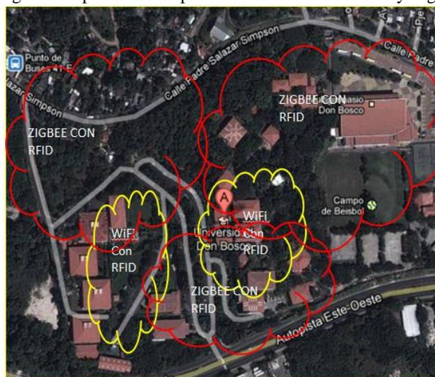
Primero identificaremos por color de nubes; las nubes amarillas representan a la transmisión WiFi, previamente instalada en la UDB-CS, la cual podemos observarla en los diferentes edificios de la universidad, con el agravante que la señal se pierde al trasladarse de un edificio a otro. Además entre más cerca estemos de
