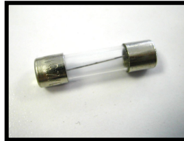
Figura 8.2.8.1 Tipo de fusible a utilizar para el sistema lector de RFID.
