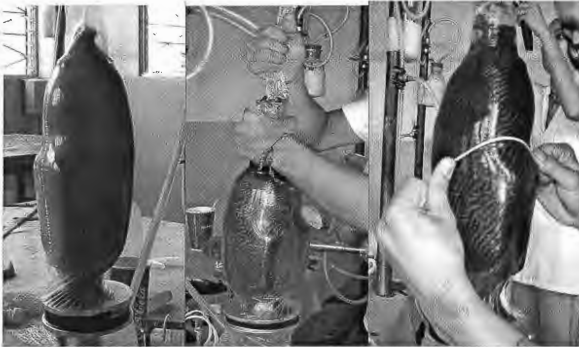
Laminación prótesis transtibial
