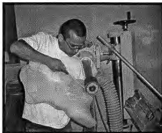
Pulido de ortesis de columna
