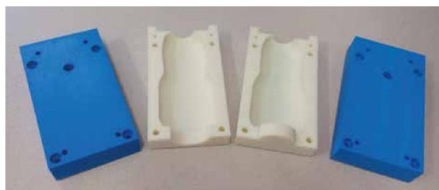
Figura 3: Moldes impresos en ABS con ayuda de la impresora Uprint SE Plus® con apoyo de software CatalystEx® (acrilonitrilo estireno butadieno)
