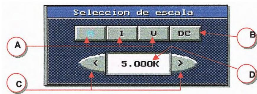
**A:** Óhmetro, Amperímetro y voltímetro.
