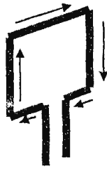
Figura 1.2- ANTENA DE CUADRO
