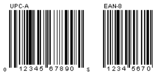
Figura 1.1.b. Ejemplo de los códigos de barra basados En los estándares UPC y EAN
