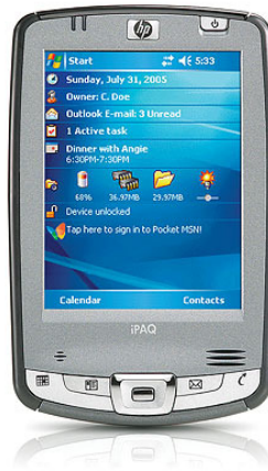
Figura 2.1.1.e IPAQ HP con tarjeta de RFID incorporada
