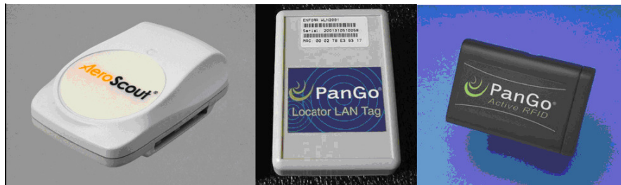
Figura 3.6.a Tags activos compatibles con WiFi (fuente: RFID Journal)
