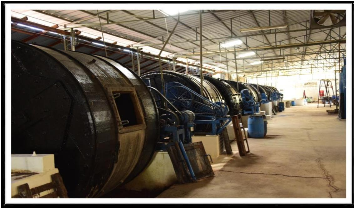
*Figura 5.1.1-3 Fotografía de los Batanes en la Área Húmeda*
