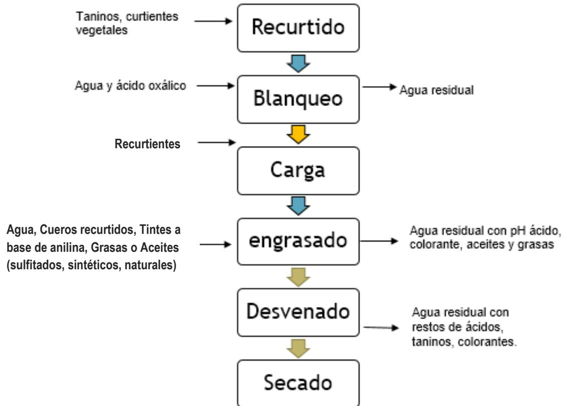
Figura 5.1.1.1-10 Flujograma de Proceso de Curtido. Tercera Etapa: Acabado en húmedo o recurtido y engrase de curtido vegetal
