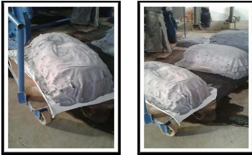
*Figura 5.1.1.1-5 Pieles apiladas, en la Etapa de Embancado o Apilado.*
