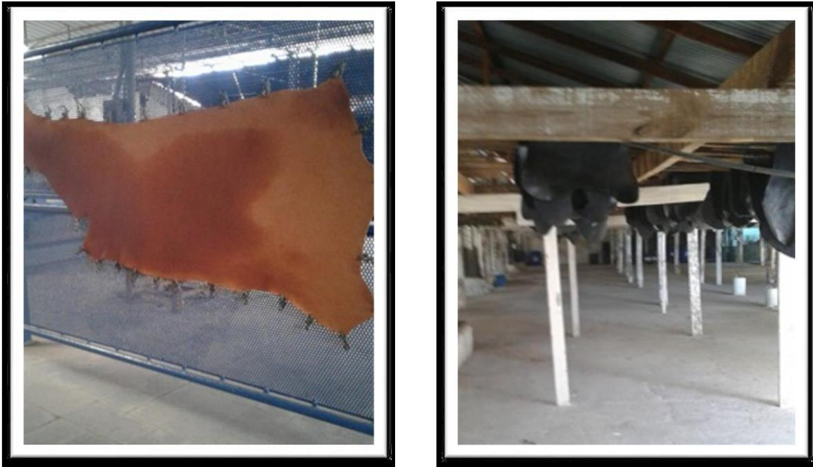
*Figura 5.1.1-4 Cueros en proceso de secado en túnel de secado y al aire libre*
