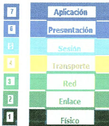
Figura 9. Representación de las 7 capas que conforman el modelo OSI.
