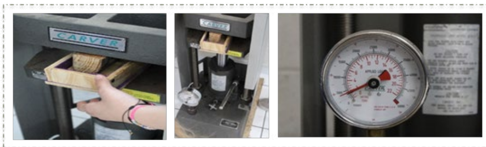
Figura 8. Prensado en la prensadora hidráulica Carver
