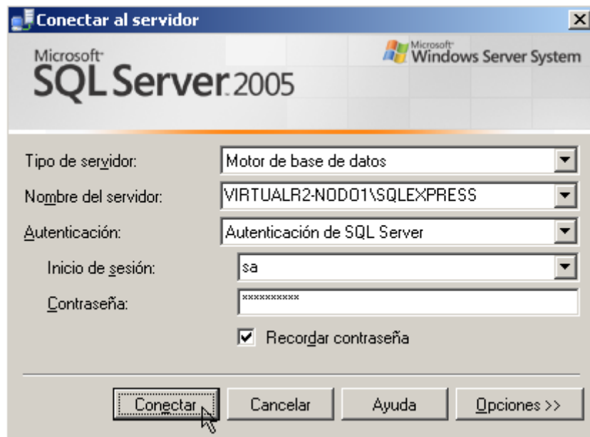
Fig. 2.4.1 Pantalla para iniciar conexión al servidor SQL Server desde el propio servidor
