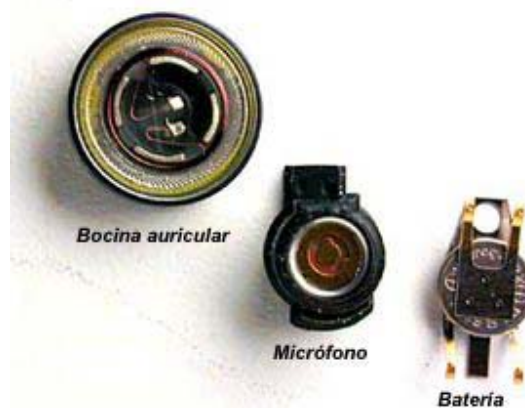
Figura 2.4 Componentes principales de un teléfono celular
