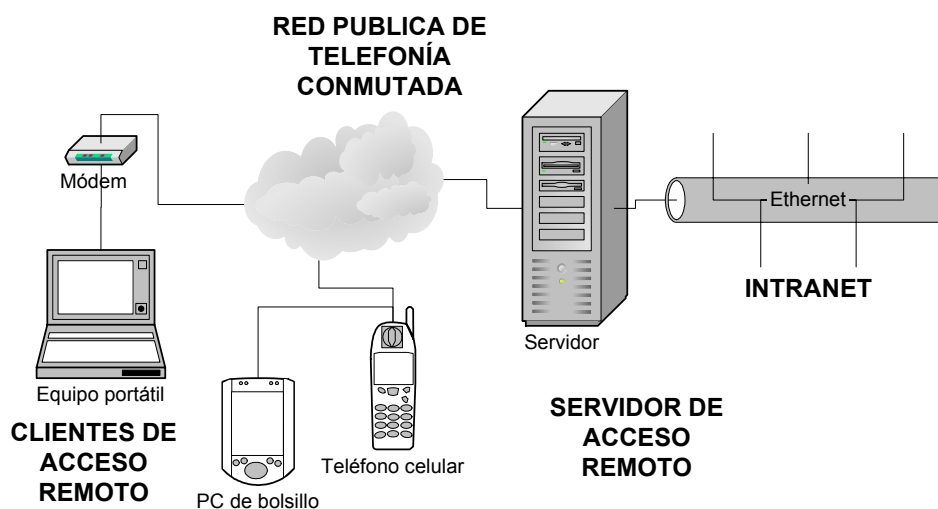
Figura 3.3: Equipo dial-up e infraestructura WAN para las conexiones PSTN
