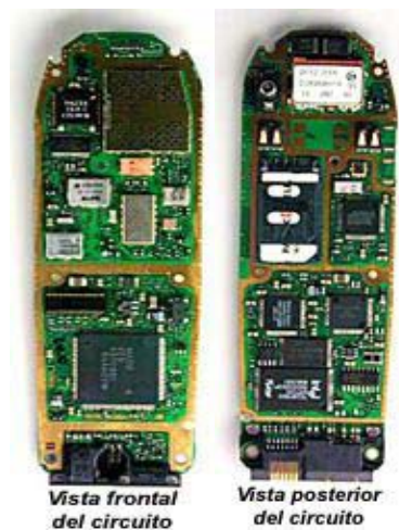
Figura 2.3 Circuito interno. Vista Frontal y Posterior
