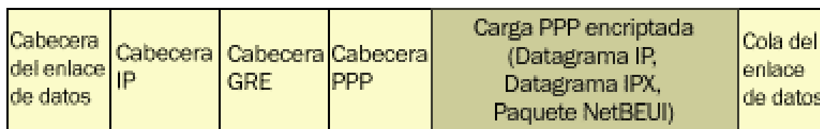
Figura 3.10: Datos del túnel PPTP.
