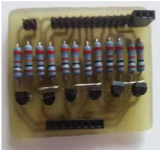
Fig 20. Circuito realizado para prueba de binario.
