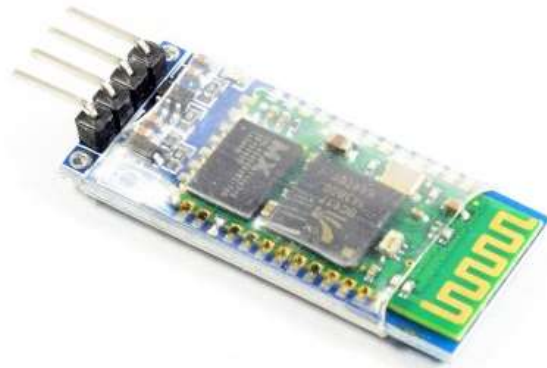
Fig 15. Módulo bluetooth HC-06
