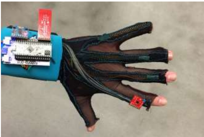
Fig. 42. Estructura de malla con resistencias cocidas en el interior para mantener estables la posición de los Flex sensor. Fuente: TheTechy.
