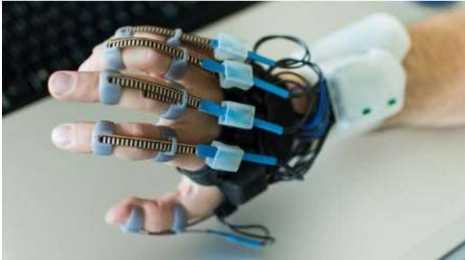
Fig. 41. Estructura de plástico hecha a partir de impresión digital, para mejor sostenibilidad y ajustabilidad de los Flex sensor. Fuente: xataka móvil
