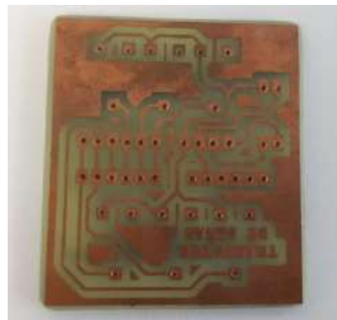
Fig. 23. Realización de pistas para circuito de pruebas de voltaje.
