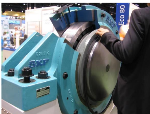
Fig. 1.25. Rodamiento (der.) y porta-rodamiento (izq.) del eje principal de baja (Cortesía de SKF).
