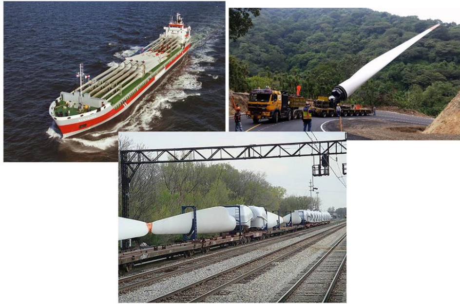
Fig. 1.43. Logística de transporte de las palas [8].
