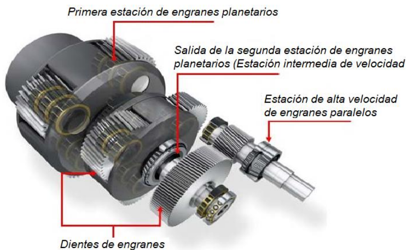
Fig. 1.30. Configuración típica de una caja multiplicadora utilizada en aerogeneradores Multi Megawatt [8].
