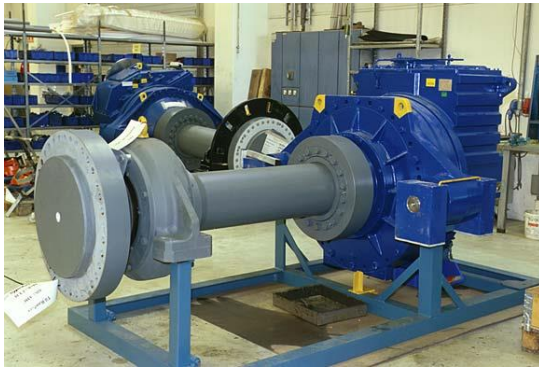
Fig. 1.24. Eje principal de baja velocidad [8].
