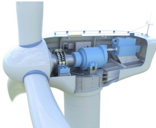
Fig. 1.26. Configuración tipo A de los rodamientos del eje principal [12].
