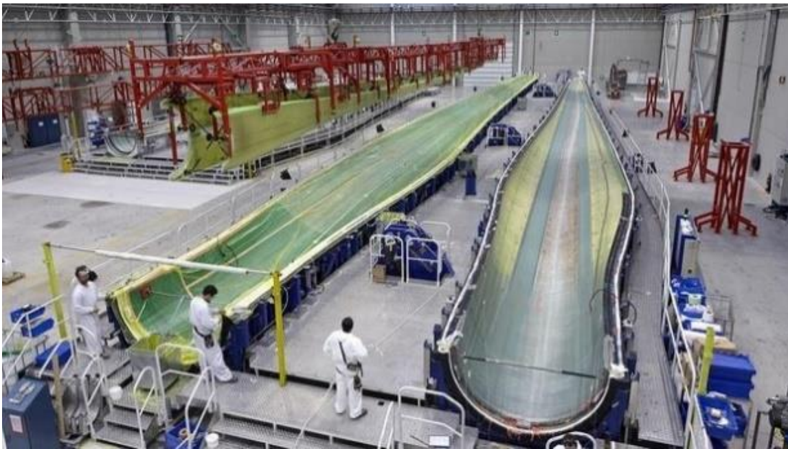
Fig. 3.3. Moldes para fabricación de las dos conchas que conforman la pala [4].
