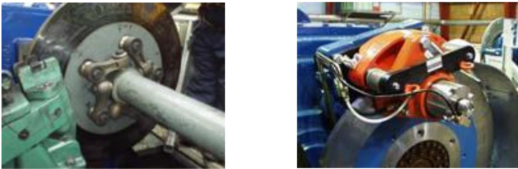
Fig. 1.32. Freno mecánico en el eje de alta velocidad de aerogenerador [13].
