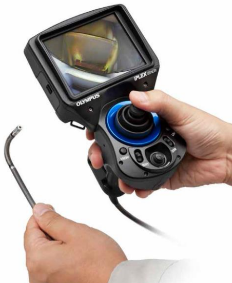
Fig. 2.5. Equipo de endoscopia de la marca Olympus [6].
