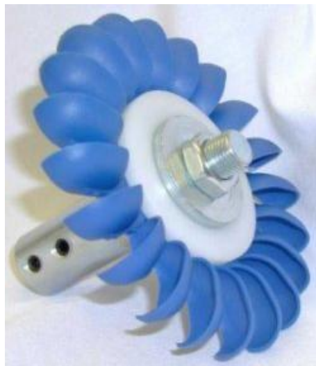
Figura 6. 2 Rodete de una mini-turbina Turgo.
