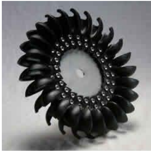
Figura 6. 1 Rodete de una mini-turbina Pelton.
