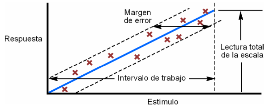
Figura 2.1.3 Definición de error y linealidad de un sistema [10]
