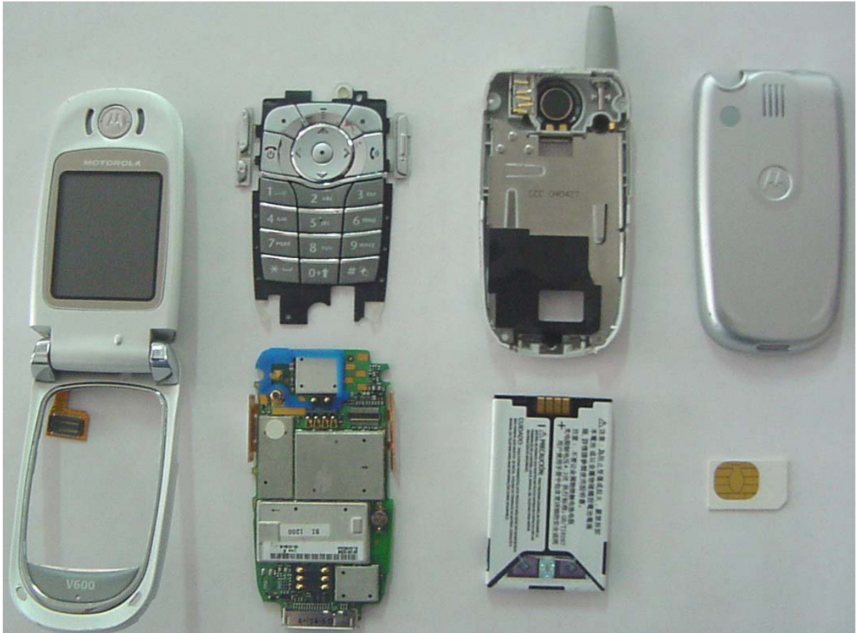
Figura 2.4.1 Partes de un teléfono móvil GSM/GPRS.
