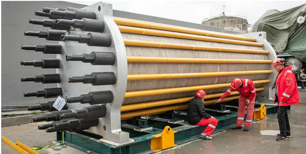
Fig. 3 Electrolizador alcalino considerado el más grande del mundo.
