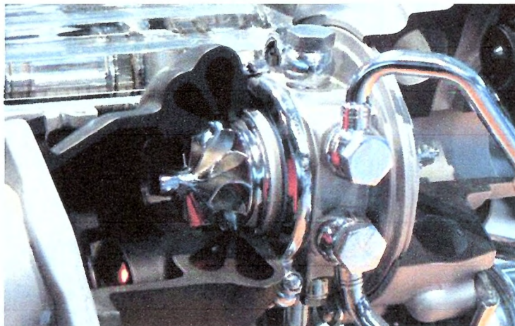
Figura 3.5-8 Turbina de flujo radial, montada en un turbocargador de coche deportivo
