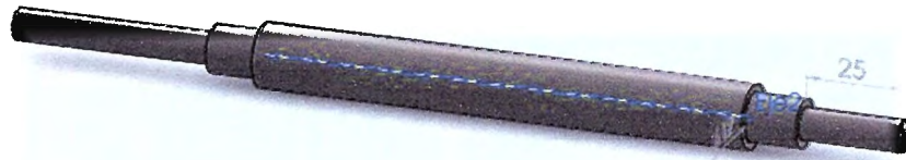
Figura 5.10-17 eje de la turbina.
