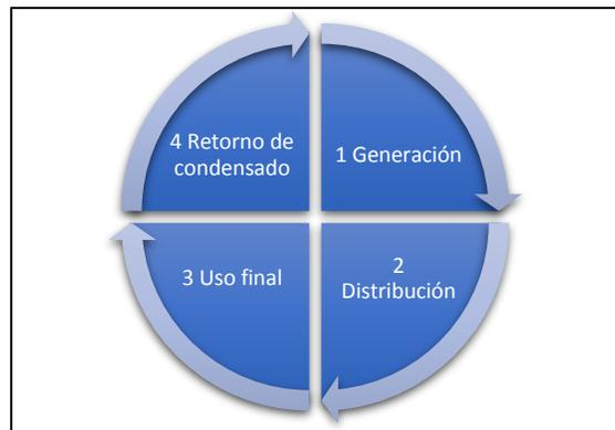
**2.4.2.1 Fase 1: Generación.** En esta fase se transforma el agua de una temperatura y presión ambiente a vapor de agua con una presión y temperatura mayor, mediante un combustible, todo esto se logra en el equipo llamado caldera, las cuales por la clasificación de la circulación del fluido dentro de los tubos de la caldera pueden ser caldera de tubos de agua donde los gases de combustión pasan por fuera de los tubos de la caldera y el agua en el interior de ellas o tubo de humo.
