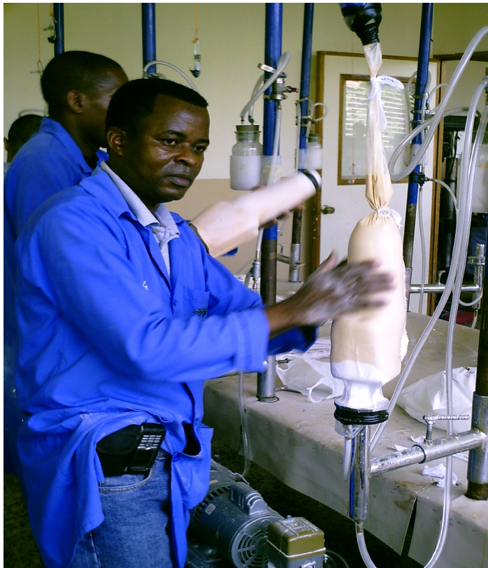
Elaboración de cuenca rígida en resina (laminación)
