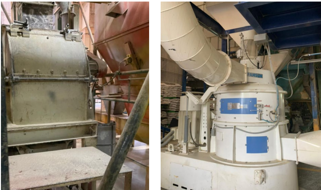
Ilustración 12. Pulverizadores 1 y 2, utilizados en Balanceados S.A. de C.V. Fuente: Equipos instalados en Balanceados S.A. de C.V.
