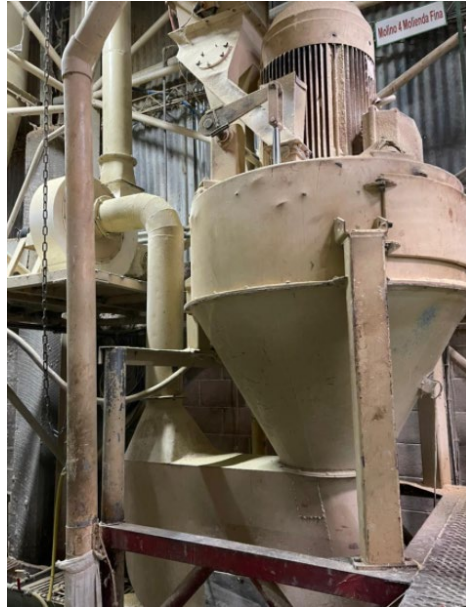
Ilustración 7. Molino vertical utilizado en Balanceados S.A. de C.V. Fuente: Equipo instalado en Balanceados S.A. de C.V.
