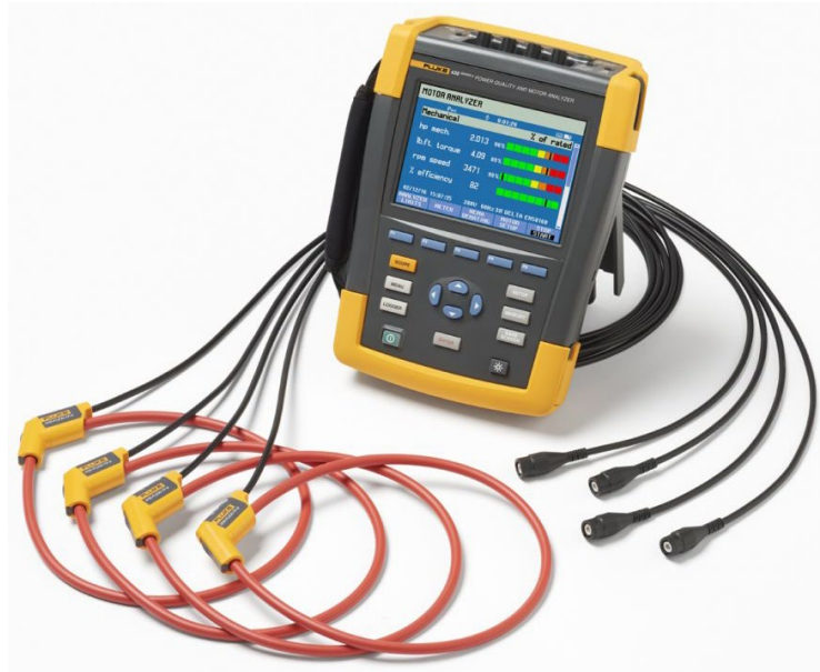
Ilustración 16. Analizador de calidad eléctrica Fluke 438-II.
