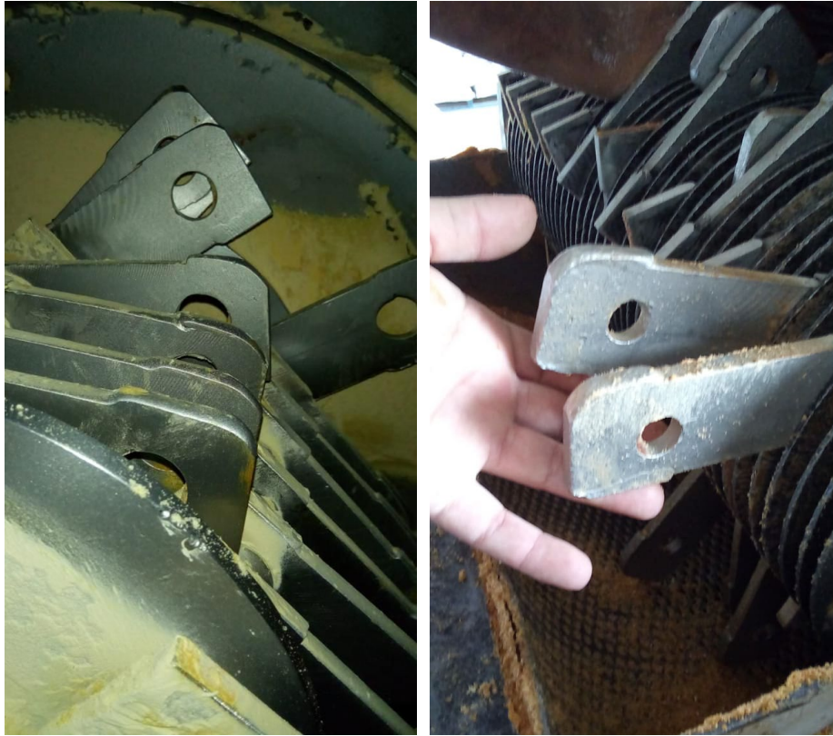
Ilustración 22. Estado actual de los martillos, se puede observar deformación en los extremos.
