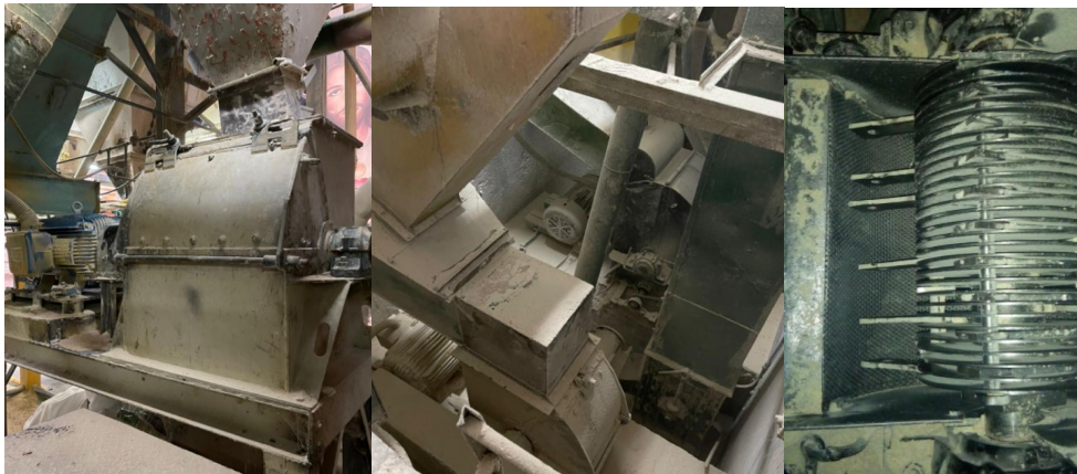
Ilustración 6. Molinos de martillos horizontales utilizados en Balanceados S.A. de C.V. Fuente: Equipos instalados en Balanceados S.A. de C.V.
