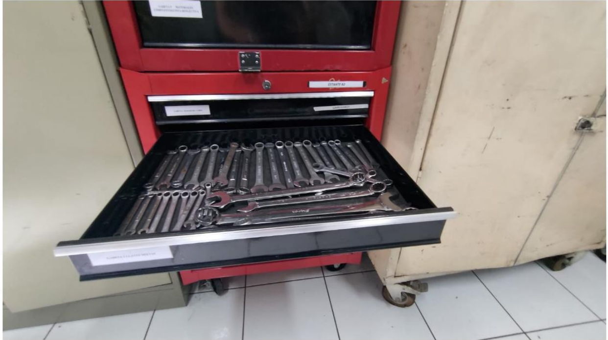
Figura 4.8. Muestra de falta de “shadowgraph” de herramientas en estante B Fuente: Fotografía tomada por el autor
