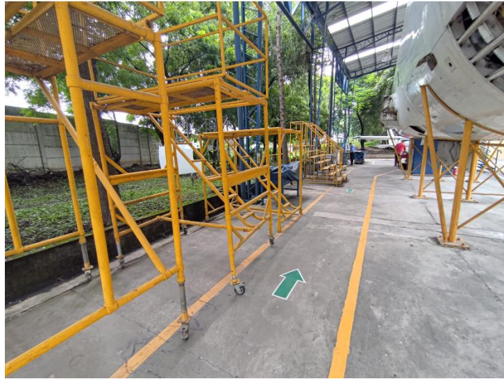
Figura 4.10. Señalización según OSHA, AAC y 5S del Hangar Fuente: Fotografía tomada por el autor
