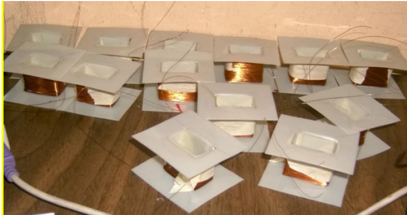
Figura 46. Bobinas recién fabricadas.
