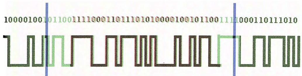
Figura 3.5 Correlación completa (código en fase) del receptor del satélite con el código PRN.
