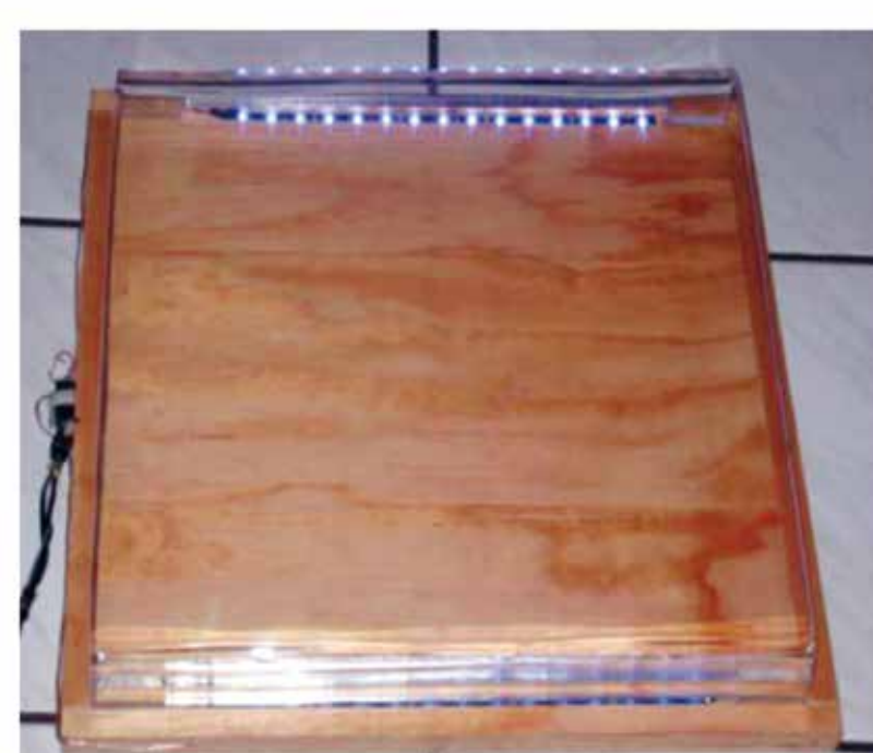
Plataforma fabricada para la adquisición de la huella plantar, construida con base de madera y acrílico transparente, reforzada con diodos LED de iluminación
