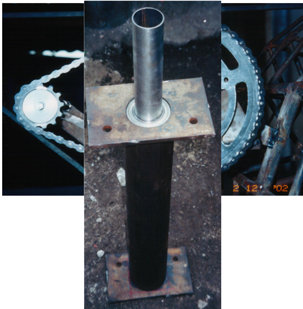
Foto 8. Chumacera de Sistema de Azimut.
