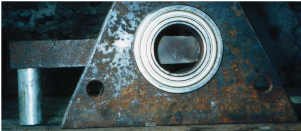
Foto 6. Chumacera de Sistema de Elevación (Vista Lateral).
