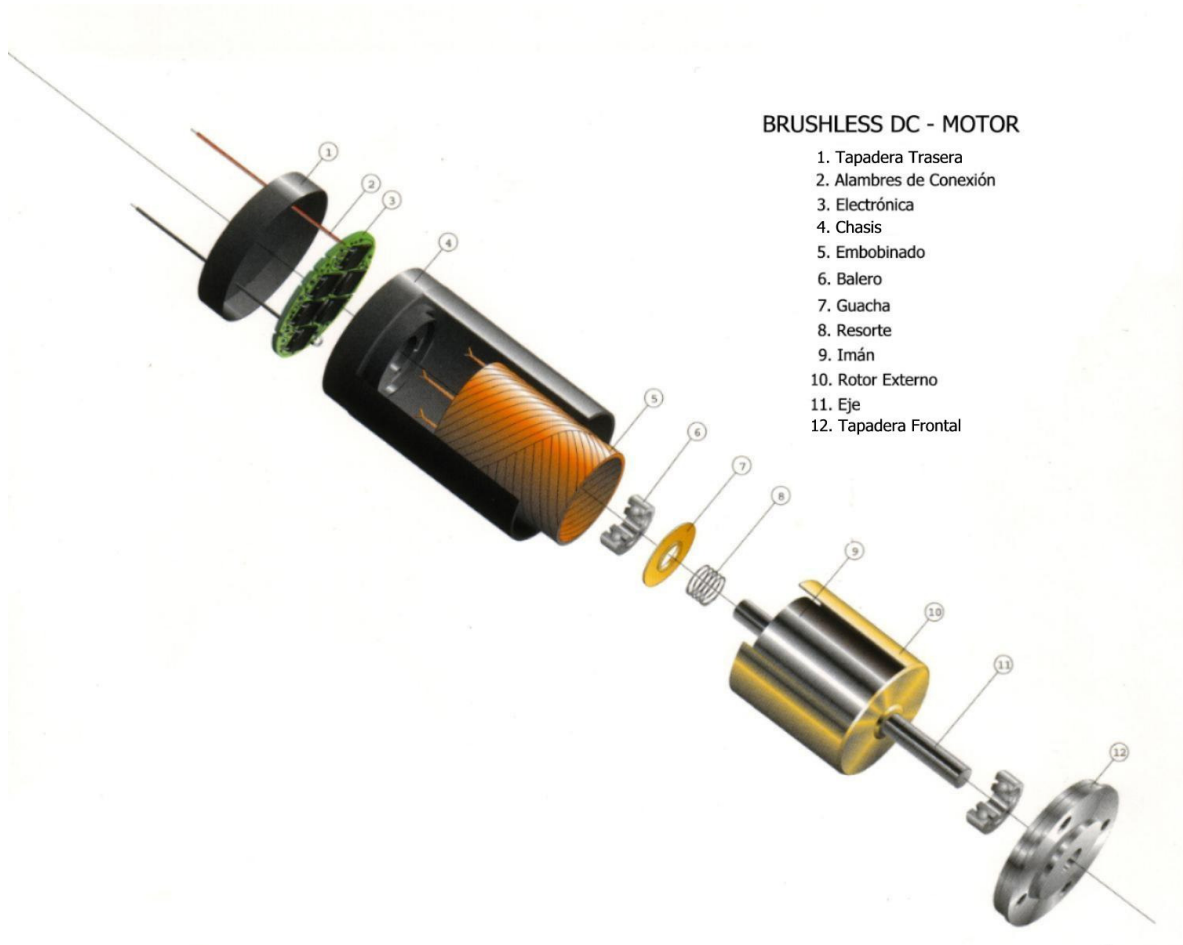
Figura 3. Diagrama de Brushless DC Motor EC22 de 20W.
