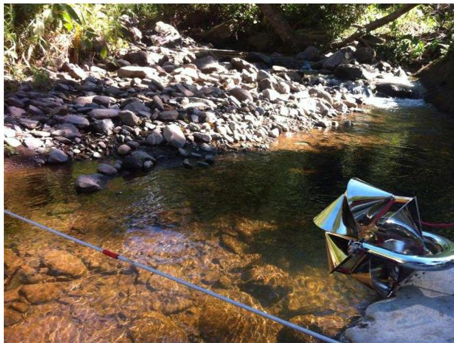
**Figura 36.** Cauce del río con cable de referencia y molinete usado para mediciones.
