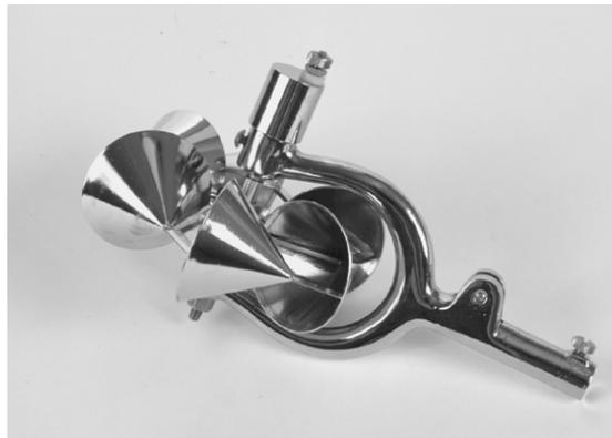
Figura 13. Molinete tipo USGS AA propuesto para campaña de mediciones.
