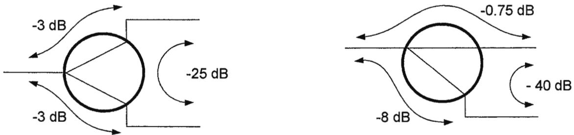
Figura 4.8 Diagrama general de un divisor y acoplador óptico.
