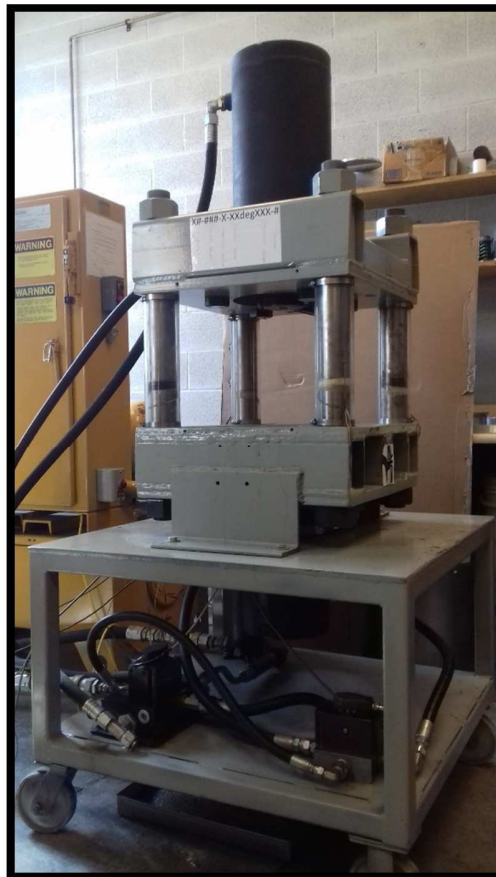
Figura 3.1 Imagen física de prensa y conjunto principal de su estructura
