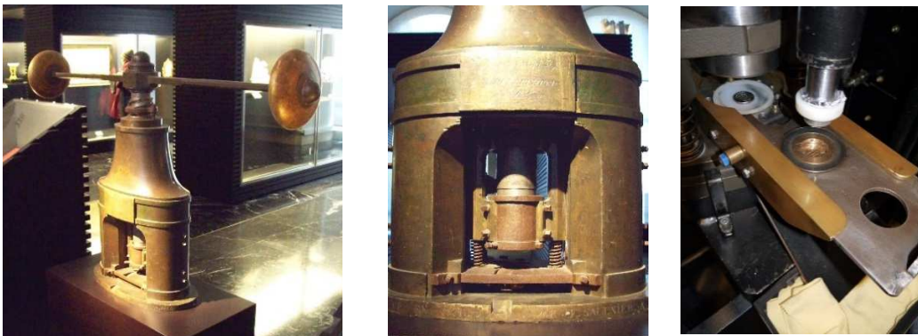
Figura 1.5. Prensa de volante francesa usada en el siglo XIX.
