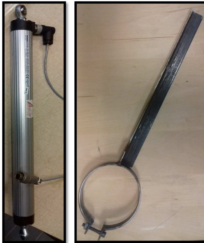
Figura 4.13 Conjunto de sensor LVDT y brazo de accionamiento.
