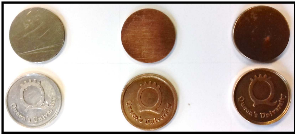
Figura 4.4 Pruebas de acuñado en tres diferentes materiales (Aluminio, Cobre, Bronce)
