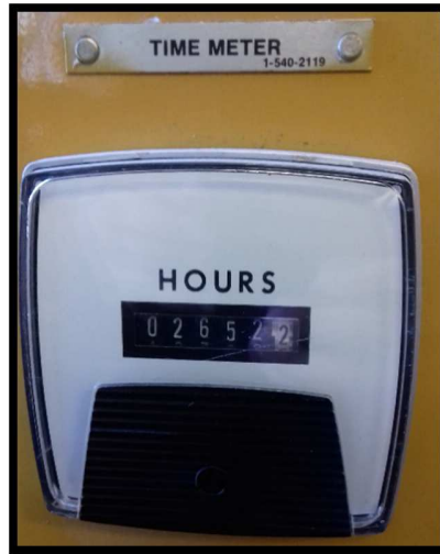
Figura 3.3 Medidor de tiempo de unidad de potencia hidráulica.
