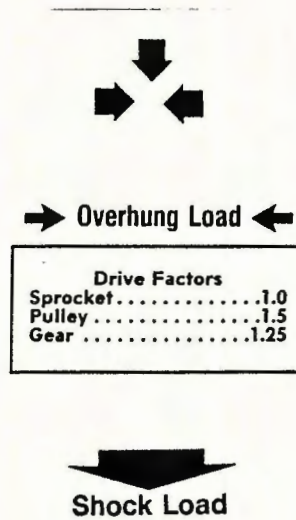
Fig. C-2. Simbología usada en los tipos de carga.
