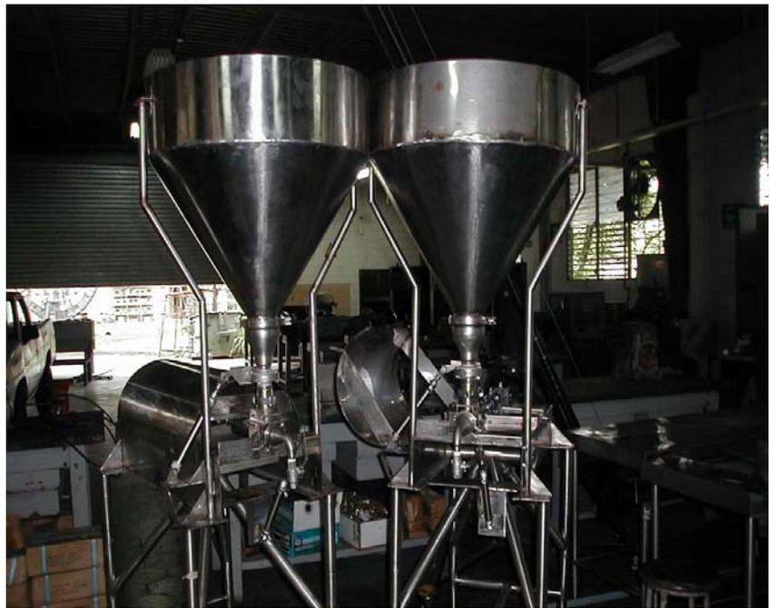
**Fotografía No.3: Dosificadora electro-neumática de accionamiento manual, para masa de Tamales de Elote.**
